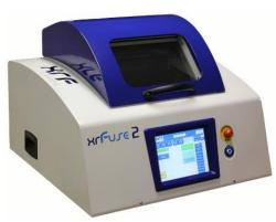
Лучшим способом для полного устранения описанных выше эффектов является метод сплавления. Высокотемпературное растворение и разложение материала с помощью флюса (плавня) и получение одно родного стекла полностью нивелирует эффекты, связанные с размером частиц и неоднородностью пробы. Метод сплавления имеет следующие преимущества:
