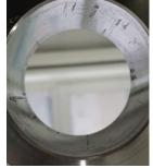
цилиндром пресс-формы приводит к заклиниванию прессформы. После разборки пресс-формы при этом появятся характерные бороздки на внутренней поверхности пресс-формы и на давящем пуансоне. Использование таких пресс-форм уже не допустимо. Для предотвращения подобных случаев рекомендуется использовать специальные засыпные
