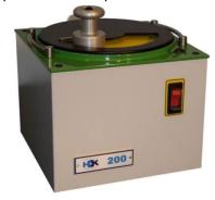
если первичное излучение параллельно им. По этой причине, современные спектрометры оборудуются системой вращения образца для уменьшения влияния ориентации пробы, что позволяет получать воспроизводимые интенсивности для измеряемых проб и стандартных образцов.
